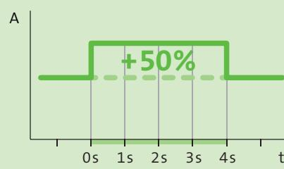
Las funciones del Limitador de Corriente y del Limitador de Potencia son excelentes para poner en marcha cargas capacitativas. Estas unidades no sólo desconectan, también reducen el voltaje o proporcionan una corriente de entrada más alta gracias a la función Powerboost.
